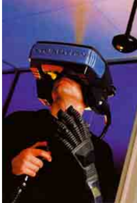
Yukarıda bir simülasyon aleti görülmektedir. Başına takılan gözlük suni görüntüler gösterirken, eldiven, insana, aslı olmayan maddelere dokunduğu hissi verir.
